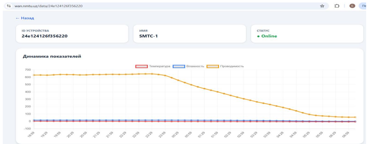
Рисунок 3. Карточка устройства: сводный график временных рядов (температура, влажность, ЕС) за выбранный период с привязкой к DevEUI и статусу узла
