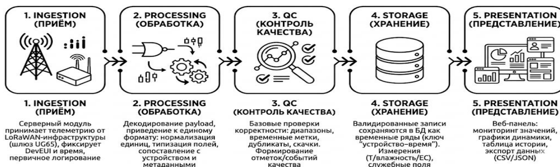
Рисунок 1. Функциональная схема обработки и представления телеметрии в веб-платформе мониторинга почвы
