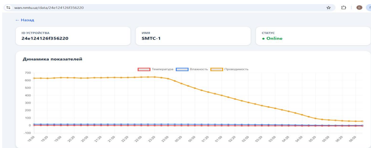
Рисунок 3. Карточка устройства: сводный график временных рядов (температура, влажность, ЕС) за выбранный период с привязкой к DevEUI и статусу узла
